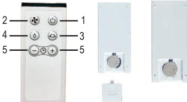
Para reemplazar la batería, deslice el panel posterior del control remoto hacia abajo para liberarlo. Retire la batería vieja y reemplácela con una batería redonda CR 2025.
