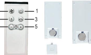
Pour remplacer la pile, faites glisser le panneau arrière de la télécommande vers le bas pour la libérer. Retirez l'ancienne pile et remplacez-la par une pile ronde CR 2025.
